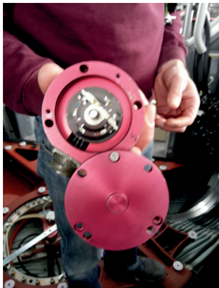
Deze sensor in de draaikranscontroller meet het overhellen.
