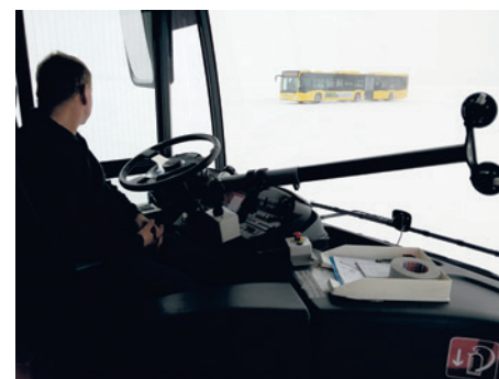
Dankzij deze stuurrobot kan je steeds exact dezelfde bocht afleggen.
