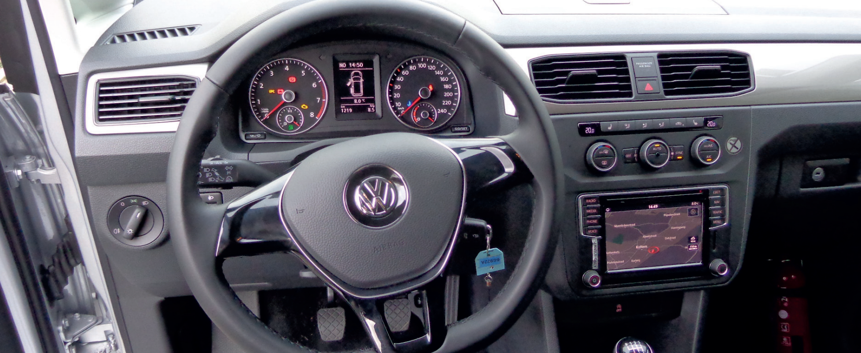
Interieur van de luxeversie op aardgas: links toerenteller met een brandstofmeter voor de gasvoorraad en een verklepperlichtje dat aangeeft dat je op gas rijdt. Rechts kilometerteller met benzinevoorraad. Het scherm van het navigatiesysteem zit wel erg laag...
