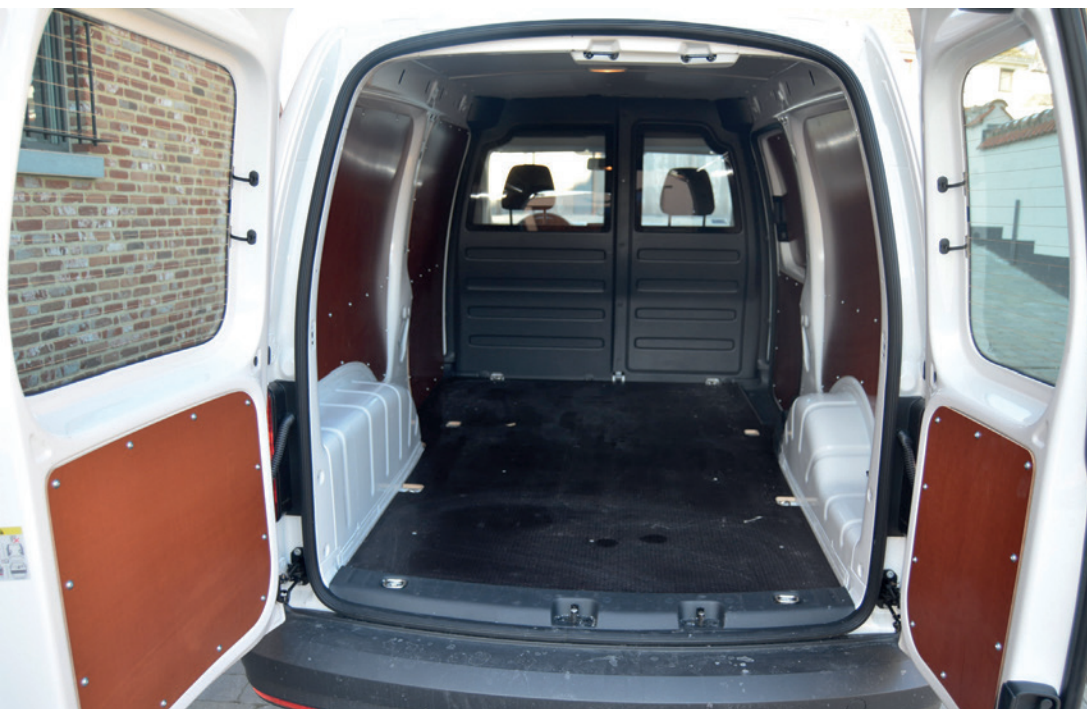
De laadruimte is achteraan toegankelijk via asymmetrische deuren. De vloer is bekleed met een PVC-laagje met minuscule noppen, er zitten ook 8 sjorogen in verwerkt.
