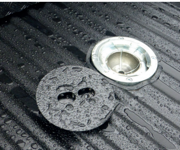
Het koppelpunt voor de trailer in de laadbak van de pick-up. De aanpassingen aan de wagen zijn erg beperkt, zodat hij nog voor andere taken kan worden ingezet.
