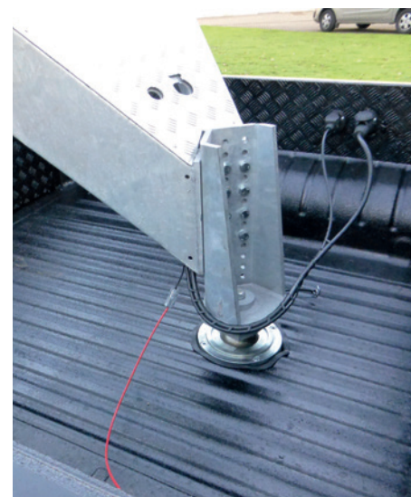
Dit is een zicht op de laadbak met gekoppelde trailer. Let op de afwezigheid van persluchtleidingen, door het elektrische remsysteem.
