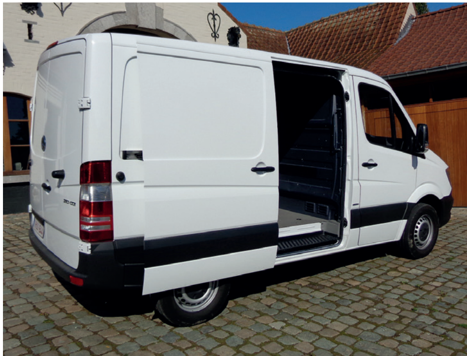
De zijdeur heeft een voldoende openingsbreedte van 1.050 mm.
