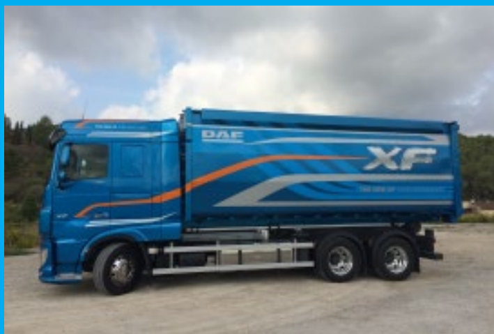
Un XL à motorisation MX-11 de 450 ch et tandem à double monte pneumatique avec essieu traîné.
