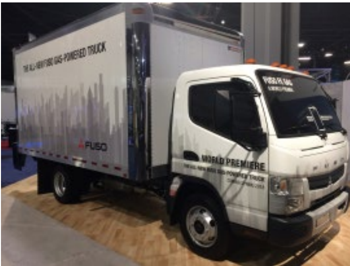
Le Fuso Canter existe aujourd'hui en version 100 % électrique, mais est encore distribué avec motorisation essence 6 l. Il sert surtout pour la desserte sur de courtes distances.
