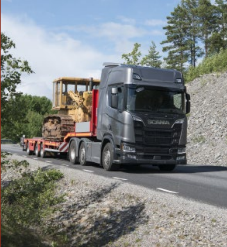
Le troisième essieu de la remorque surbaissée demeure directionnel jusque 30 kilomètres à l'heure; ensuite, il se rigidifie.
