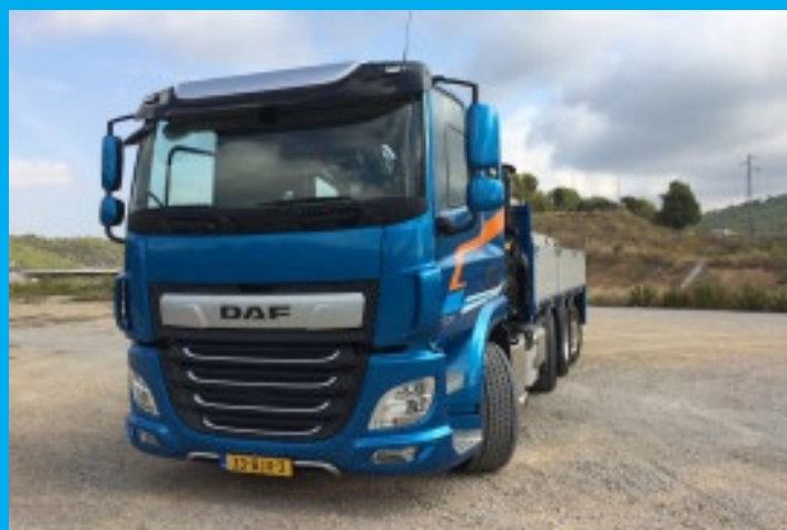
Le rayon de braquage est particulièrement court grâce aux deuxième et quatrième essieux dirigés.
