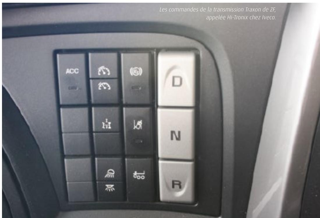
*Les commandes de la transmission Traxon de ZF, appelée Hi-Tronix chez Iveco.*
