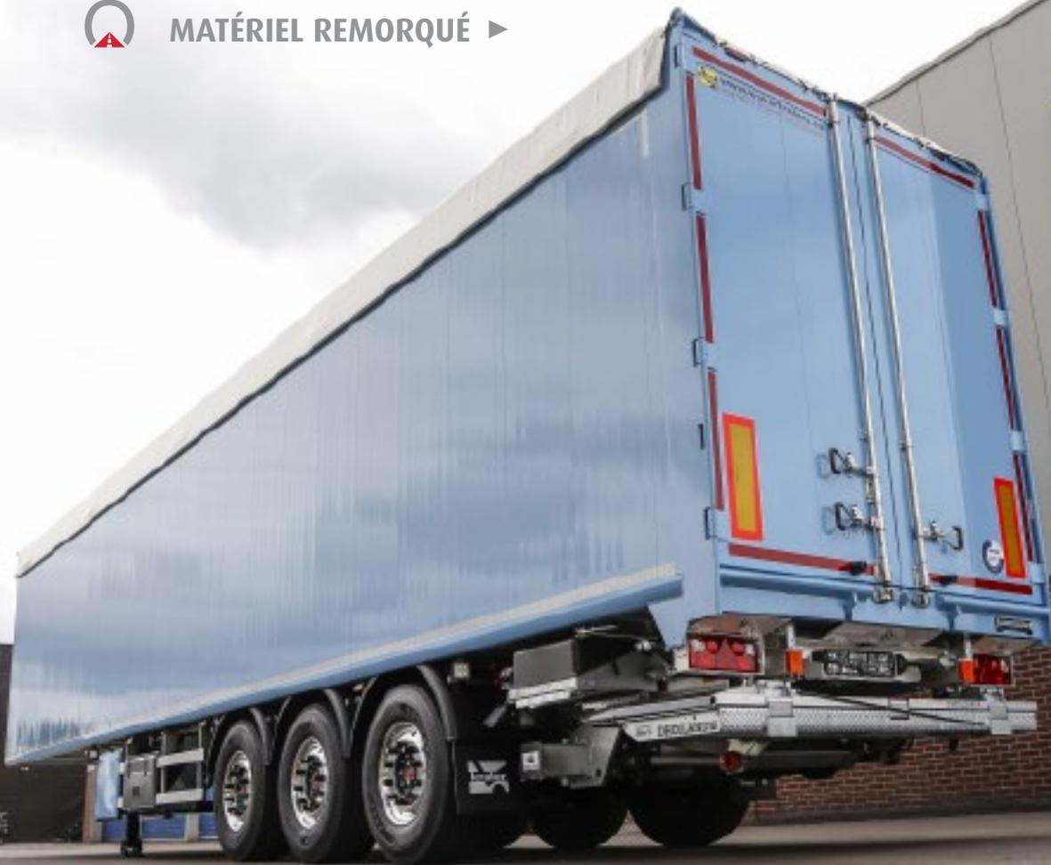
Contrairement aux autres remorques K-Force, le châssis de la variante HD est soudé, et non plus boulonné.
