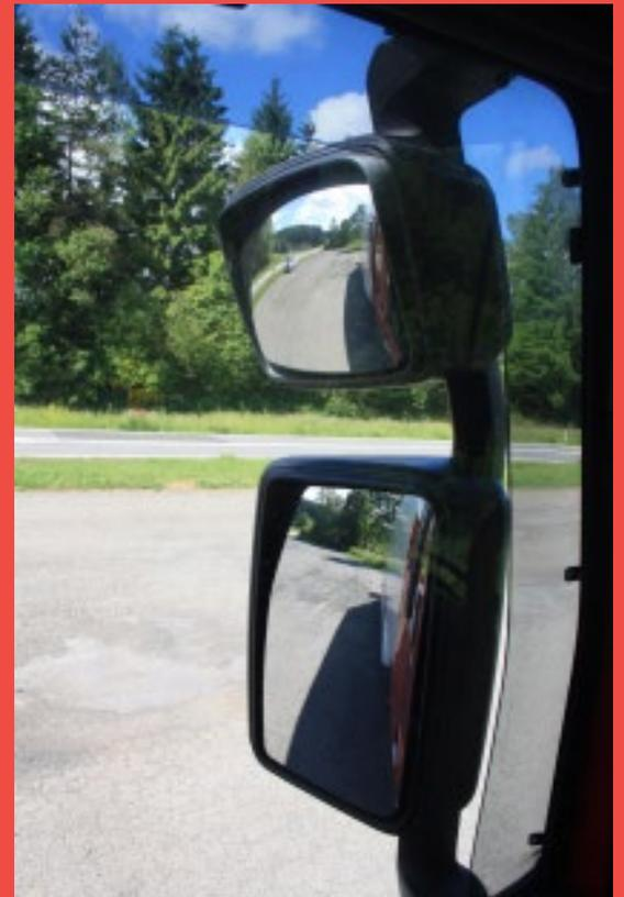
Les rétroviseurs sont suffisamment étroits pour ne pas entraver la visibilité dans les carrefours.
