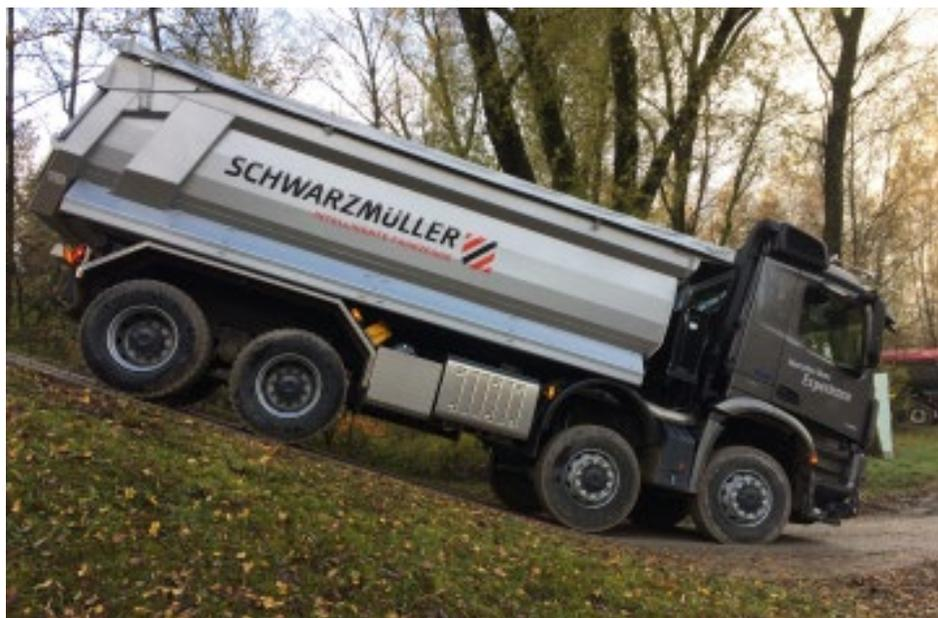
Ce 8 x 8 avec TRK est ici photographié en marche arrière avec un train de 32 t, sur une rampe de 60° (SIC).
