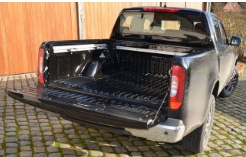
Le bac de chargement permet de loger une europalette entre les roues.
