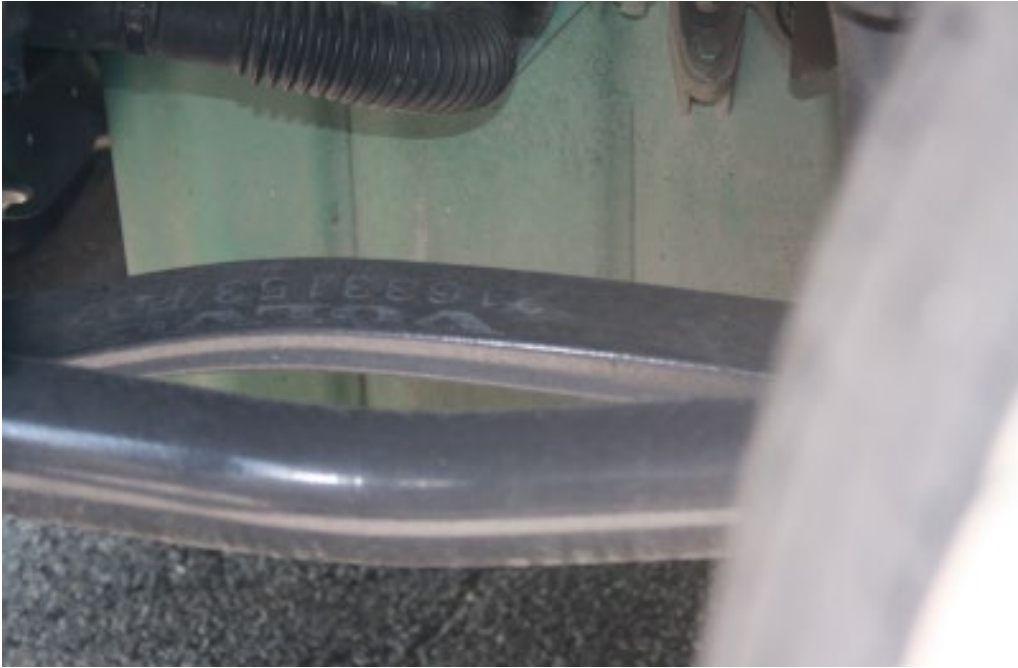
Derrière la tringle grise, le ressort à lame simple, qui permet d'économiser du poids
