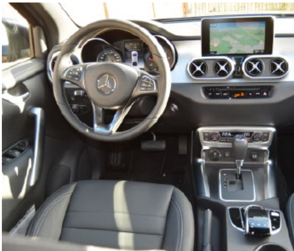
L'intérieur se distingue directement par de nombreux éléments typiquement Mercedes, dont le volant. La boîte de vitesses automatique est encore pilotée à l'aide d'un pommeau central, au lieu d'une petite palette à droite du volant.
