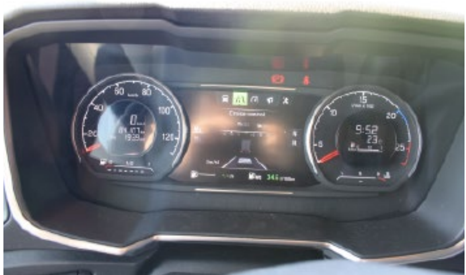
Un grand moniteur central sur le tableau d'instruments de bord; les renseignements additionnels sont affichés sur de petits écrans au milieu du tachymètre et du compte-tours.
