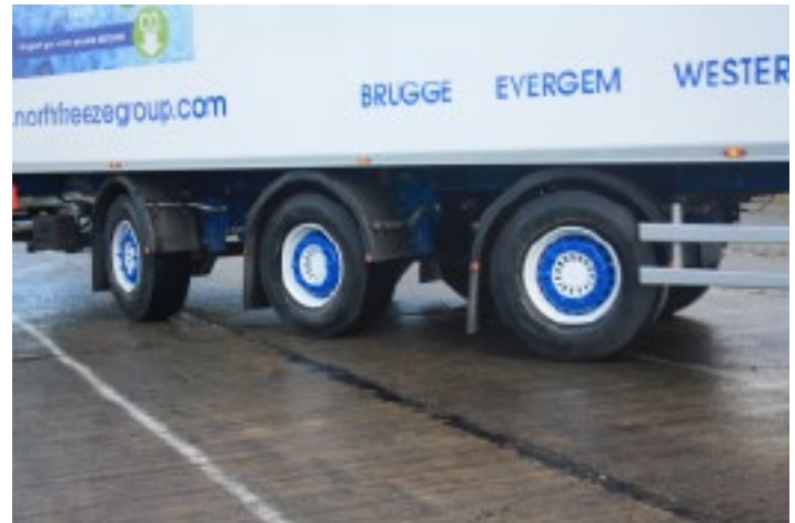
Le module X-Steering diminue le rayon de braquage et l'usure des pneumatiques.
