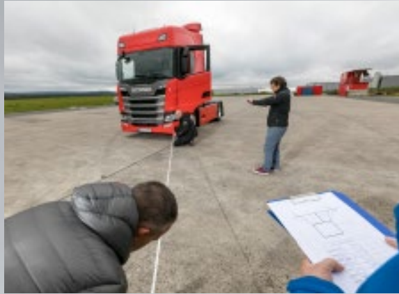
C'est ici que sont mesurés les angles morts autour de la cabine.
