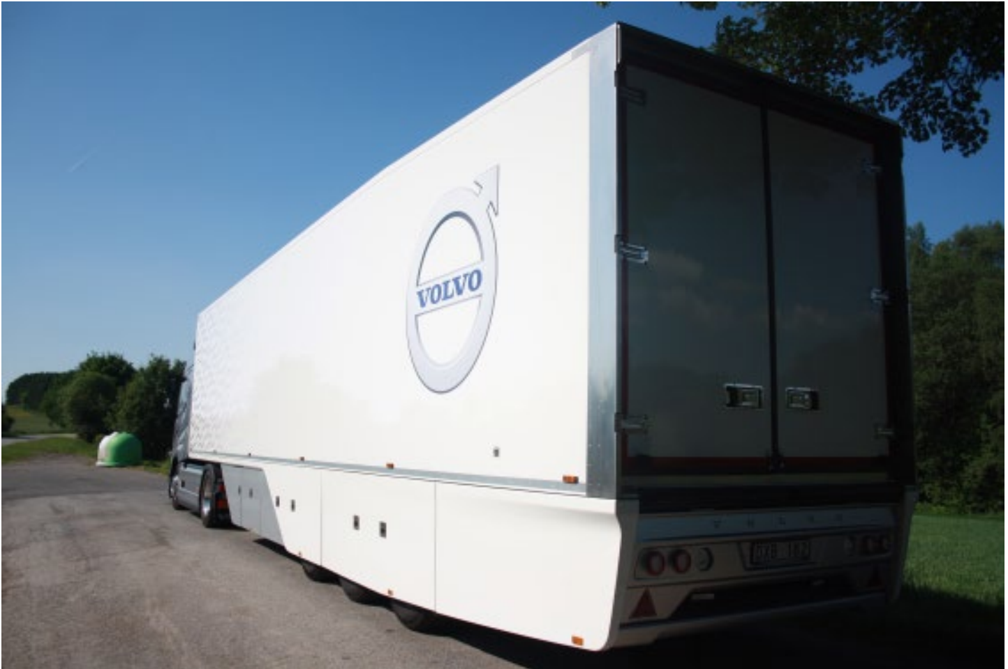
Le FH Lightweight avec sa remorque carénée fin prête pour le test.
