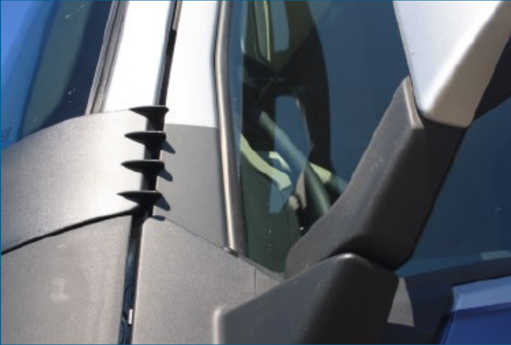
Raffinement aérodynamique : des nageoires qui gardent propres les rétroviseurs et les vitres latérales.
