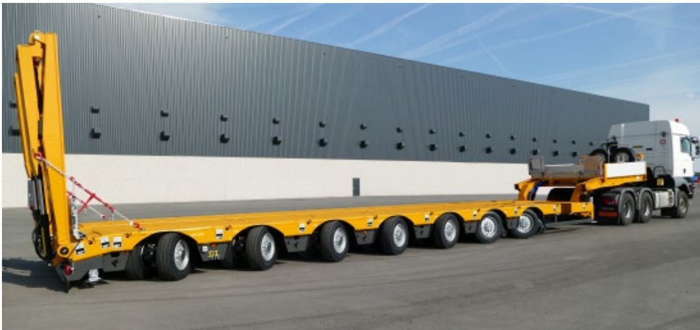
La conduite demeure possible malgré la faible hauteur de chargement des essieux pendulaires Faymonville PA-X.
