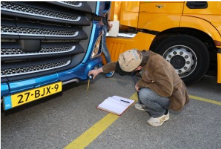
On compte 235 mm entre le sol et le bas du pare-chocs du DAF.
