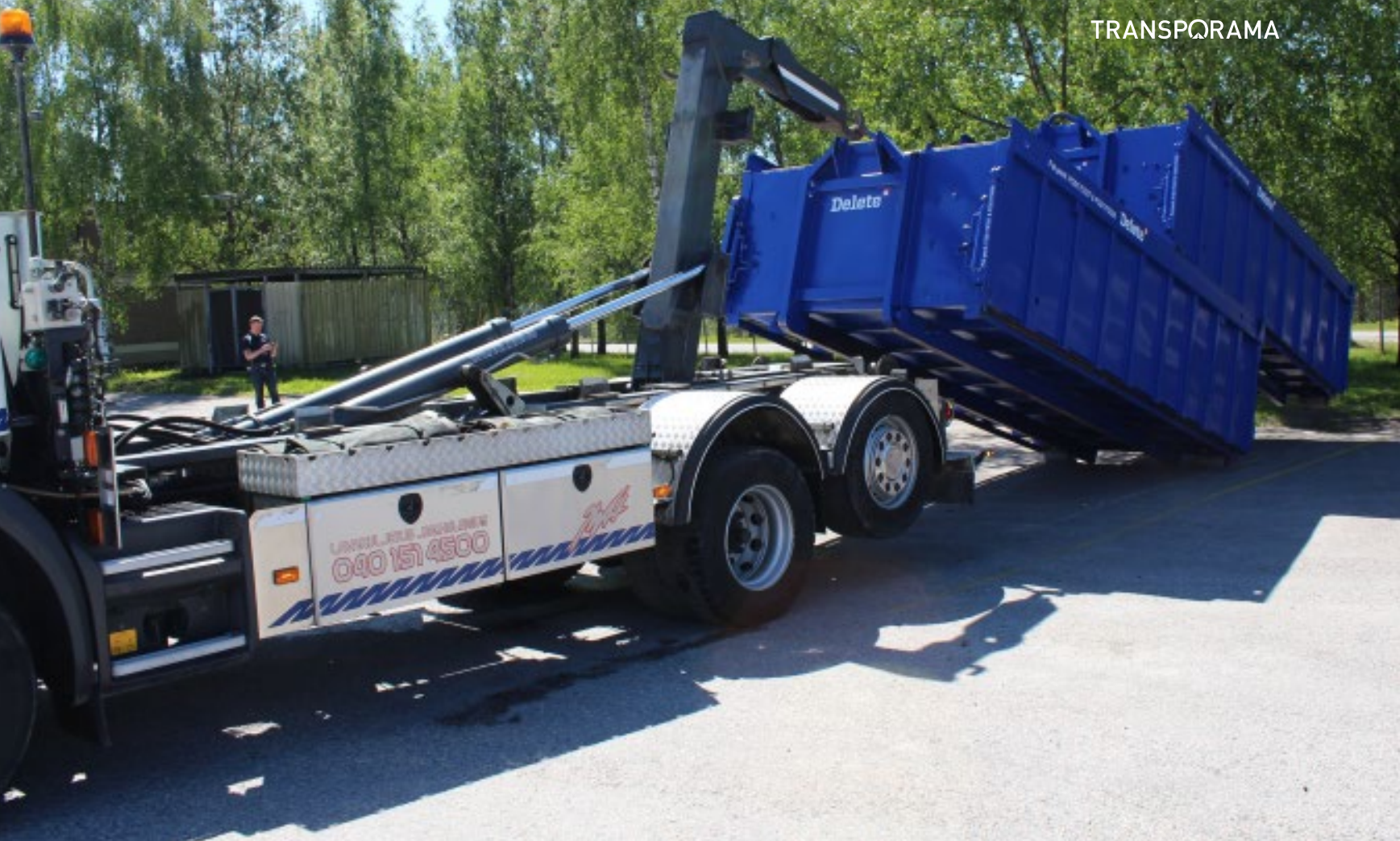
La manutention simultanée de deux conteneurs à déchets fait gagner énormément de temps. C'est le Skip Up de Deleto.
