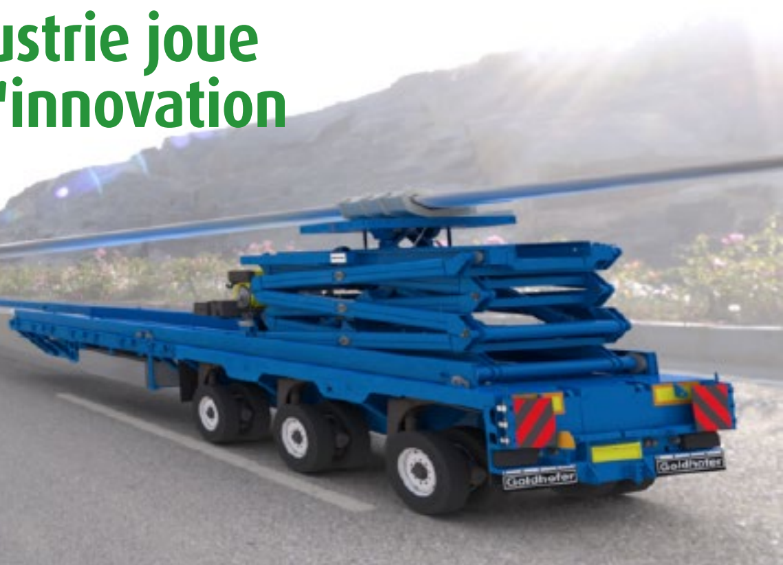
La pointe de la pale repose sur une plate-forme rehaussable sur le Bladex de Goldhofer.
