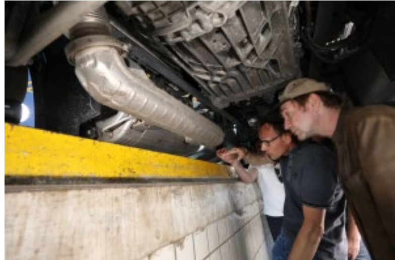
Le pot d'échappement a pivoté pour gagner en garde au sol.
