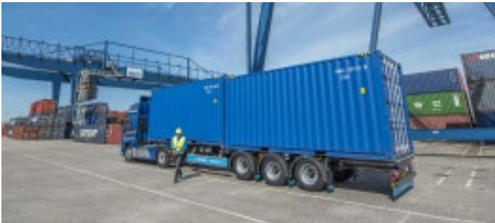
Fini les problèmes de répartition des masses des containers. Avec le système de pesage de D-Tec sur le Flexitrailer, l'opérateur dispose de tous les renseignements utiles.
