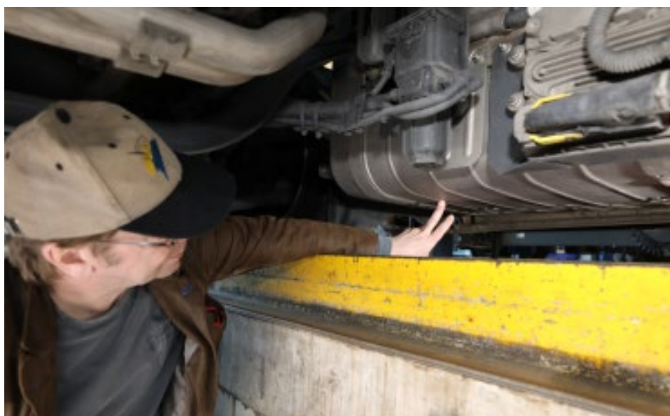
Il reste 22 cm sous le pot d'échappement de l'Actros, c'est bien suffisant.
