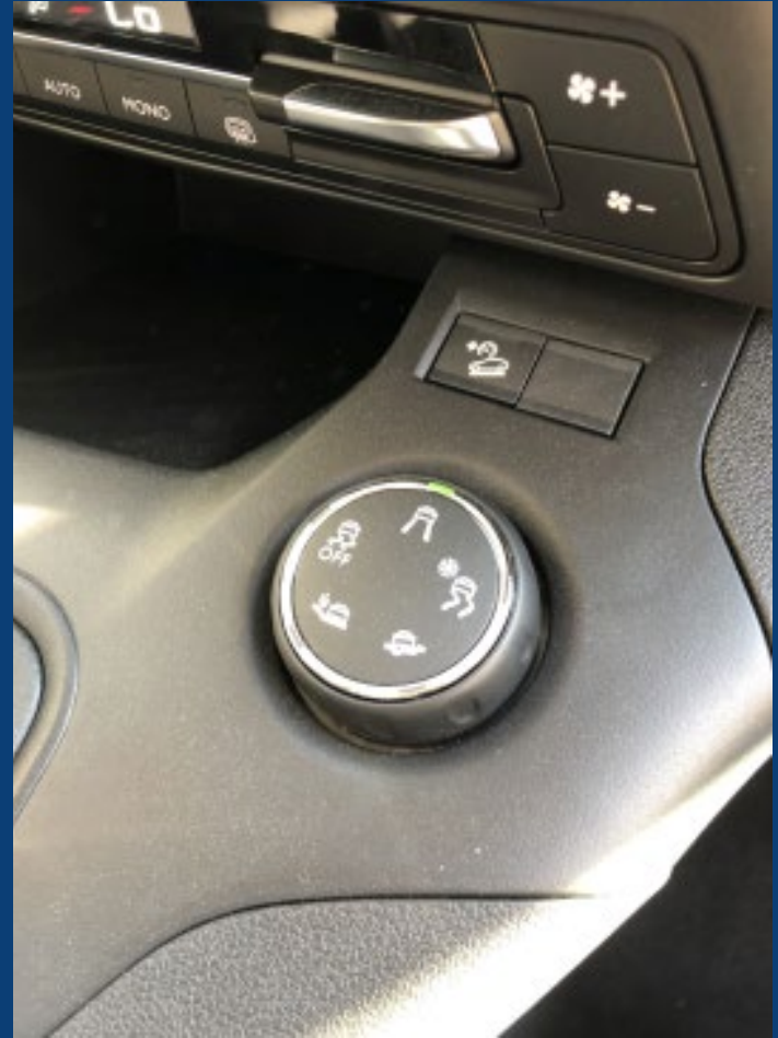
La molette de sélection permet de choisir 5 modes afin d'adapter le véhicule, de type Worker, à l'état du revêtement.
