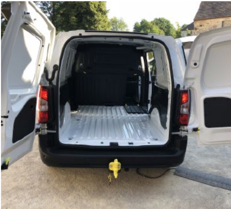
Le coffre est accessible au moyen de portes asymétriques ou d'un hayon plus classique.
