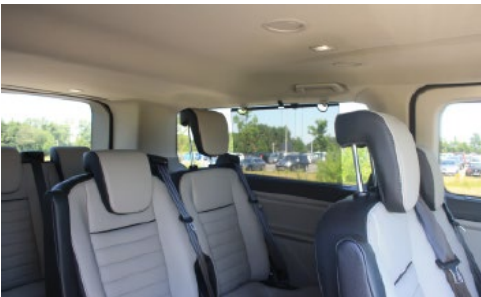
Un système supplémentaire de climatisation d'air a été installé pour les passagers à l'arrière.
