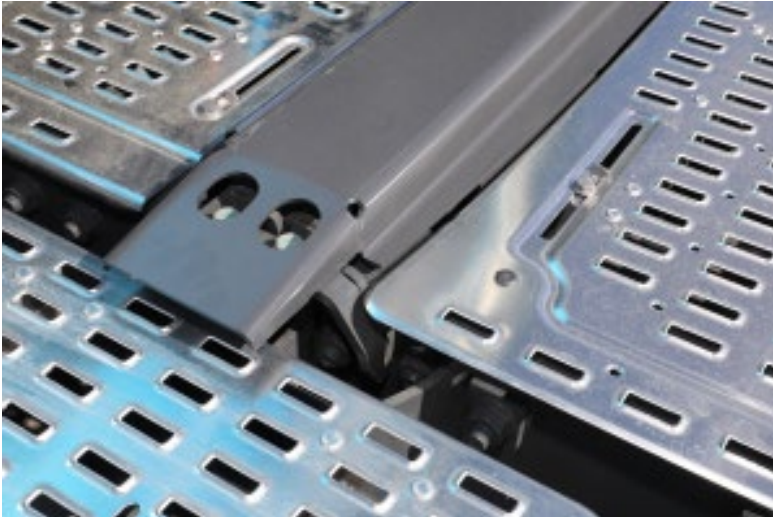
Chez DAF, le châssis est protégé contre l'embout de la remorque.
