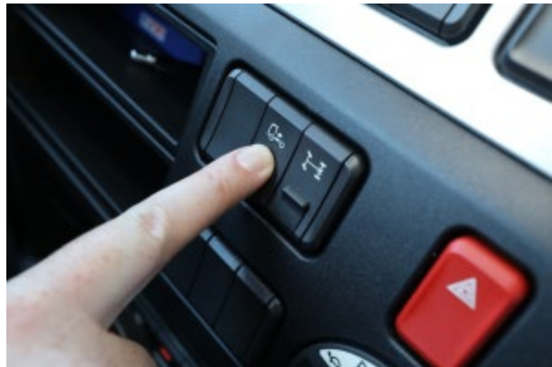
Un commutateur très pratique sur le tableau de bord pour choisir la hauteur voulue.
