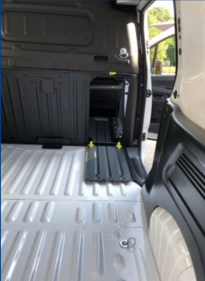
Photo de l'espace de chargement avec le volet mesurant 612 x 298 mm.
