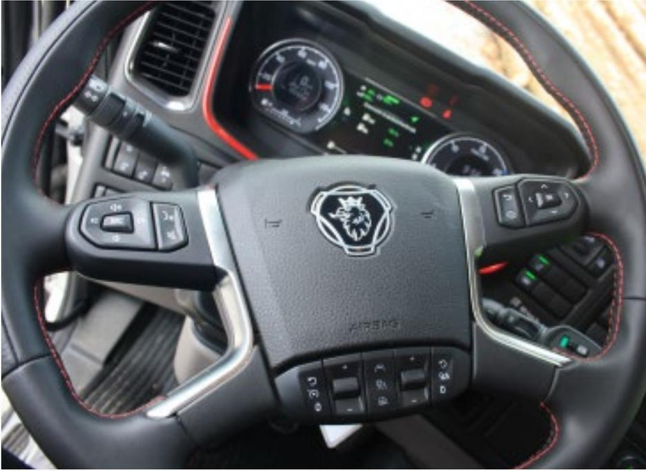
Scania a installé sous le volant les commutateurs pour régler l'ACC et la vitesse de descente.
