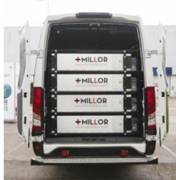
Les batteries sont logées dans le porte-à-faux arrière, ce qui nuit à la stabilité de la conduite.
