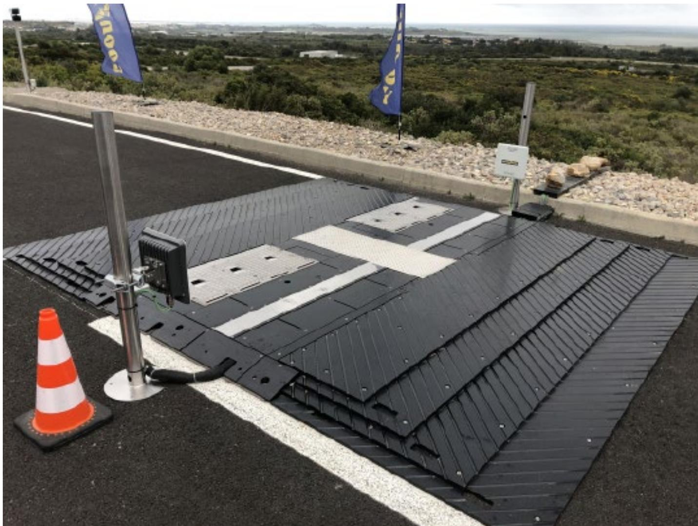
Le Goodyear Drive-Over-Reader a recours à des caméras et des lasers pour vérifier le bon état des pneus.
