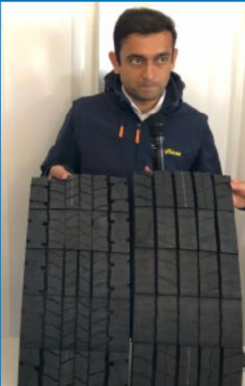
Plus le pneu s'use, plus des sillons s'ouvrent dans le profil, afin de garder une adhérence constante. Voyez la différence avec l'ancien profil, usé.
