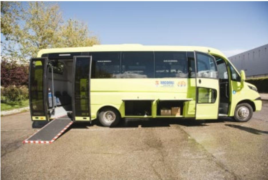
Sous le plancher du véhicule sont aménagées deux soutes à bagages.
