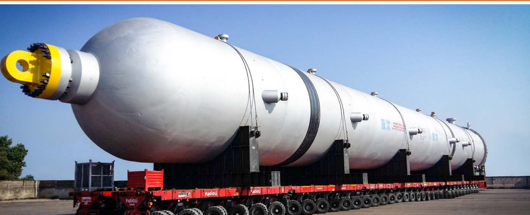
5 | Fagioli a transporté cette immense cargaison pesant 1535 tonnes grâce à 72 essieux livrés par Cometto.
