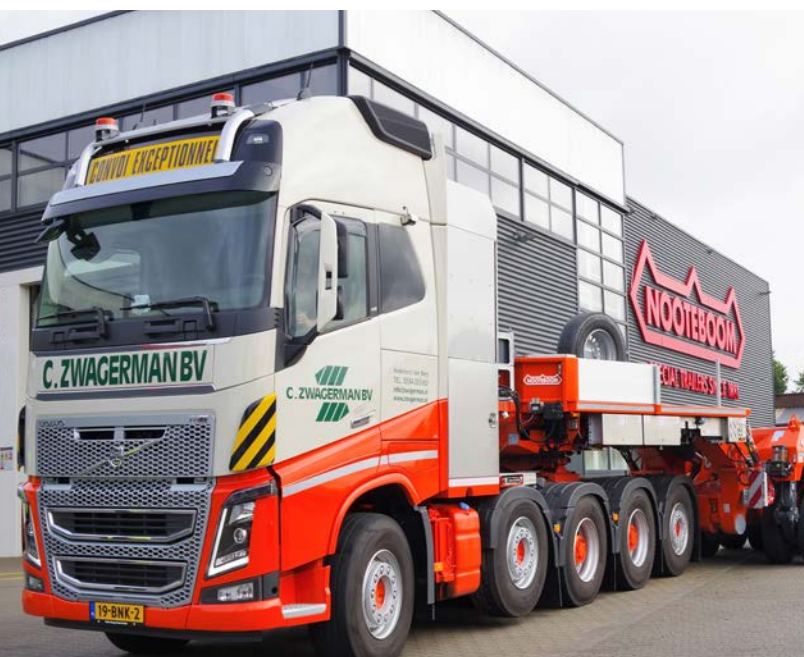
8 | La semi-surbaissée Nootboom 4+6 Euro-PX de Zwagerman.
