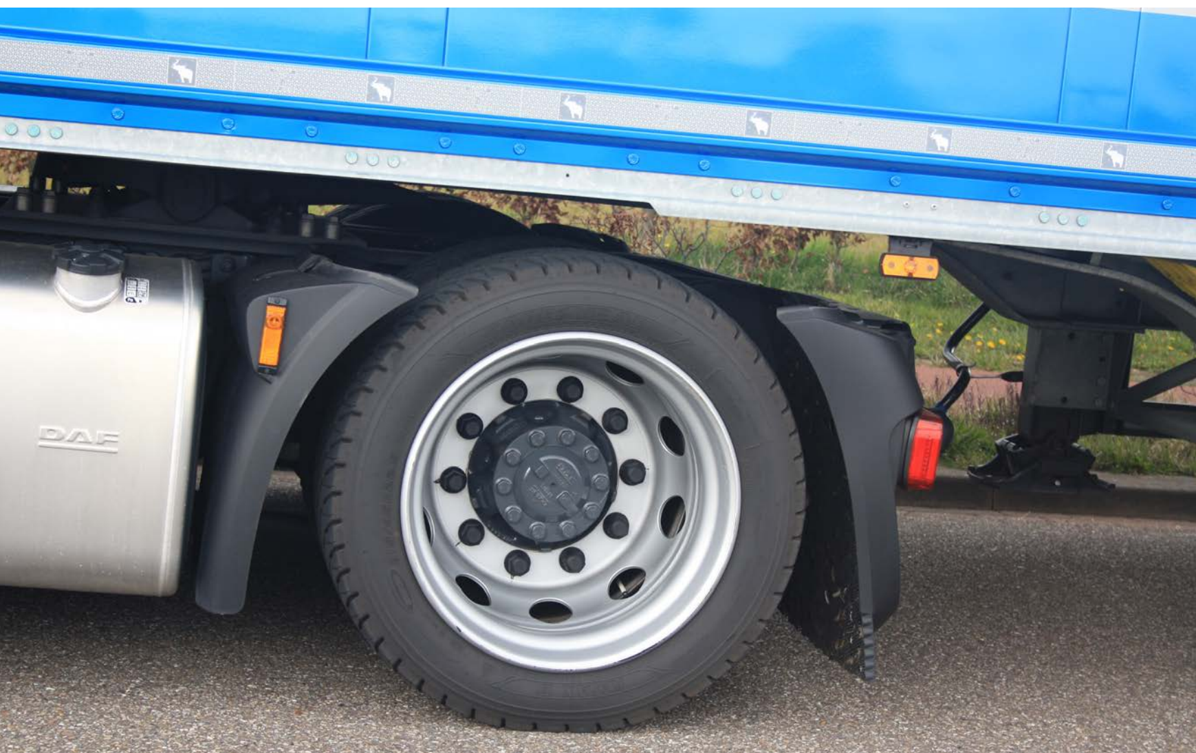
Il y a très peu d'espace entre la partie supérieure de la roue et le plancher de cette semi-remorque.
