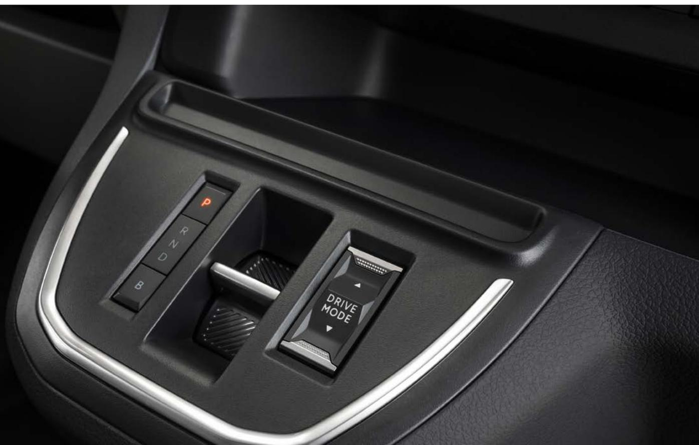
La molette pour le choix du mode de transmission aurait pu être plus grande. À côté, l'interrupteur pour choisir le mode de conduite.
