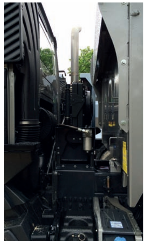
De koeler van de Optitrack wordt zeer compact achter de cabine ingebouwd.
