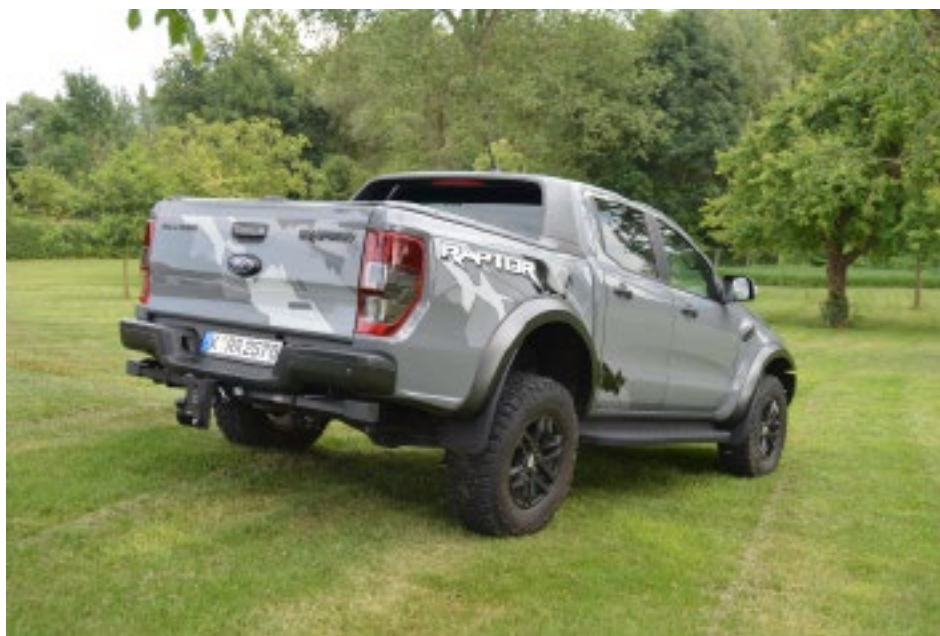
Le modèle d'essai avait aussi une ferrure d'attelage, d'une capacité de traction freinée de 2500 kg.
