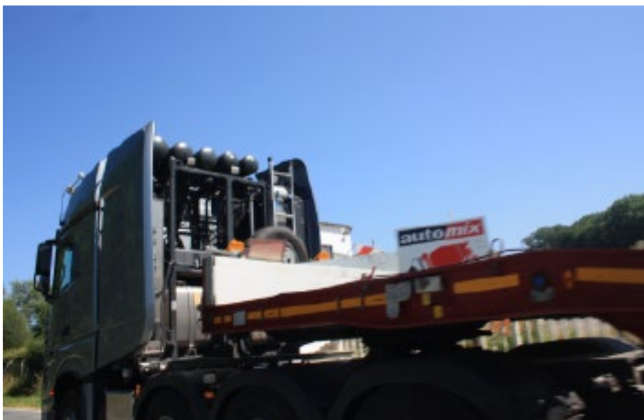
Les réservoirs d'air comprimé, le réservoir de carburant et les équipements de refroidissement ont été installés à l'arrière de la cabine.
