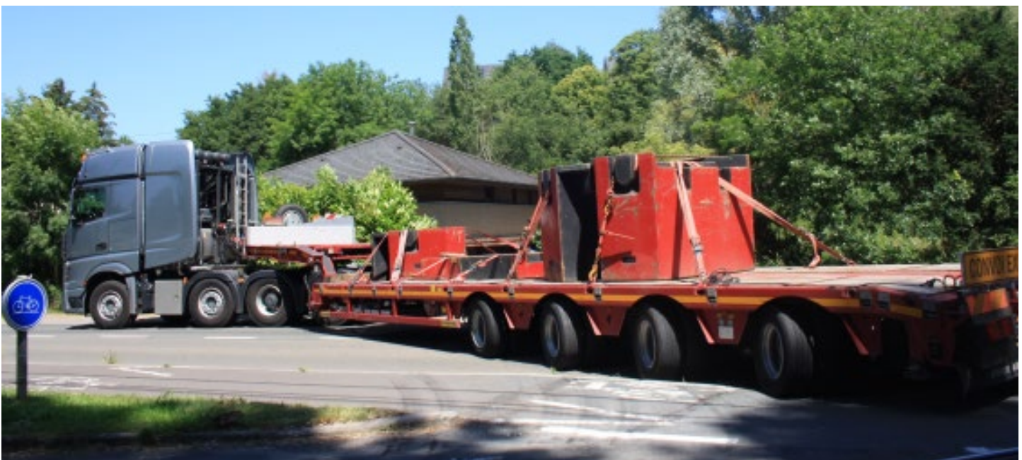
Par rapport à une semi-remorque ordinaire, il faut ici prendre les virages très différemment.
