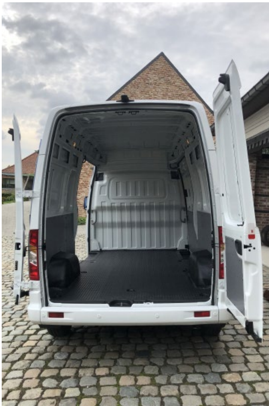
Observez Le caisson de chargement avec 8 oeillets d'arrimage et habillage standard à crampons. La deuxième porte latérale coulissante est en option.
