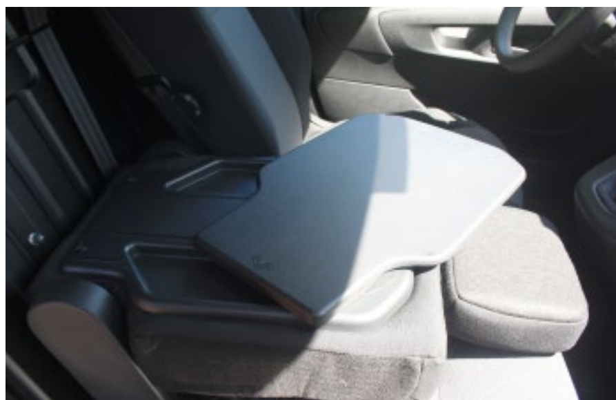
Le siège du passager se replie pour former une petite tablette d'appoint.
