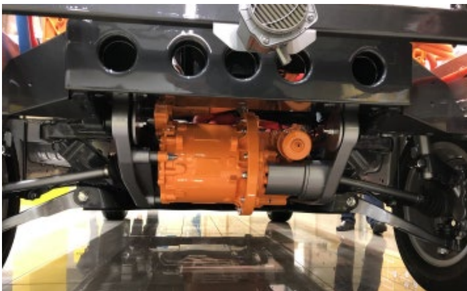
Le moteur électrique alimente les roues avant et rend toute boîte de vitesses superflue.
