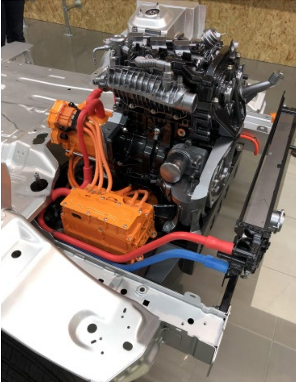
La centrale énergétique compacte du Transit PHEV. Le moteur à combustion se trouve sur le haut, les composants électriques sont indiqués en orange.
