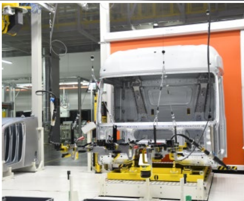
C'est ici que la structure de la cabine est vérifiée une seconde fois.
