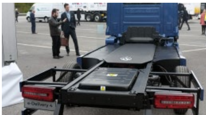
Les batteries sont disposées entre les poutres du châssis.
