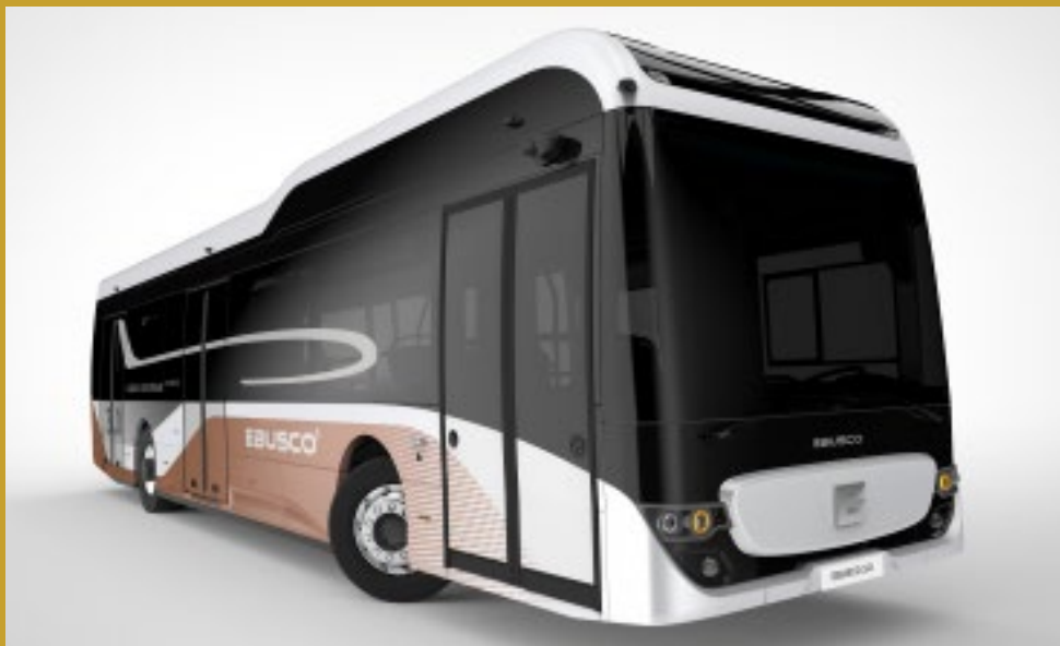
Ebusco 3.0 a provoqué une petite révolution par sa carrosserie en matières plastiques.
