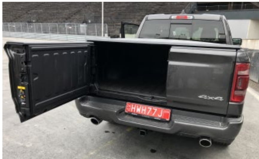
Le RAM était un véhicule hors-concours, simplement présent pour collecter des données. Et peut-être pour inspirer d'autres constructeurs, par exemple avec son hayon divisé en 2 parties?
