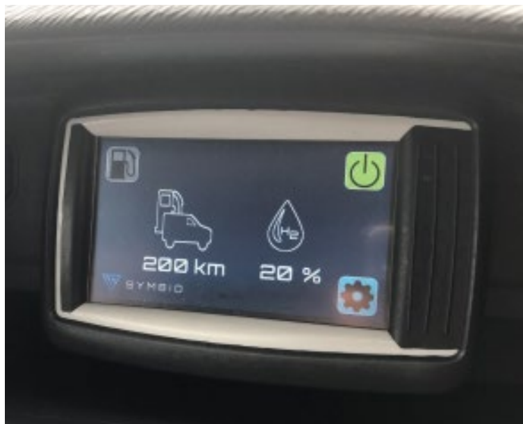
Un écran supplémentaire indique la réserve d'hydrogène et l'autonomie estimée.
