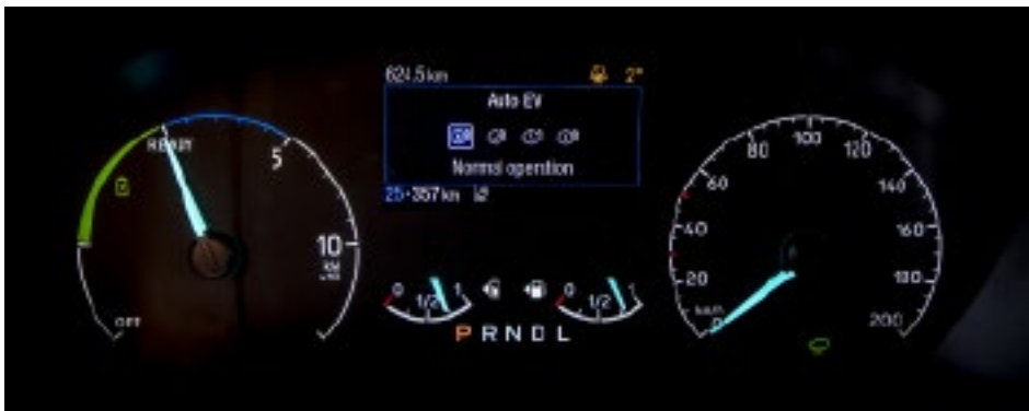
Le tableau de bord du Ford Custom PHEV. On voit à gauche un panneau combiné qui affiche le niveau de charge, au milieu en bas la réserve de batterie et d'essence, au-dessus l'autonomie et l'indication du choix de la source d'énergie et à droite le tachymètre.
