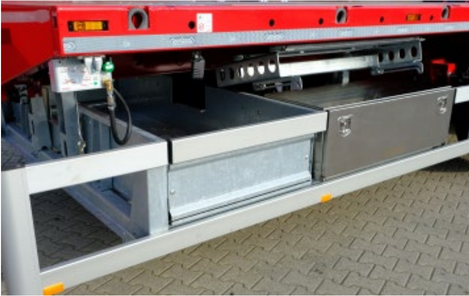
Observez l'astucieuse installation des coffres à outils.
