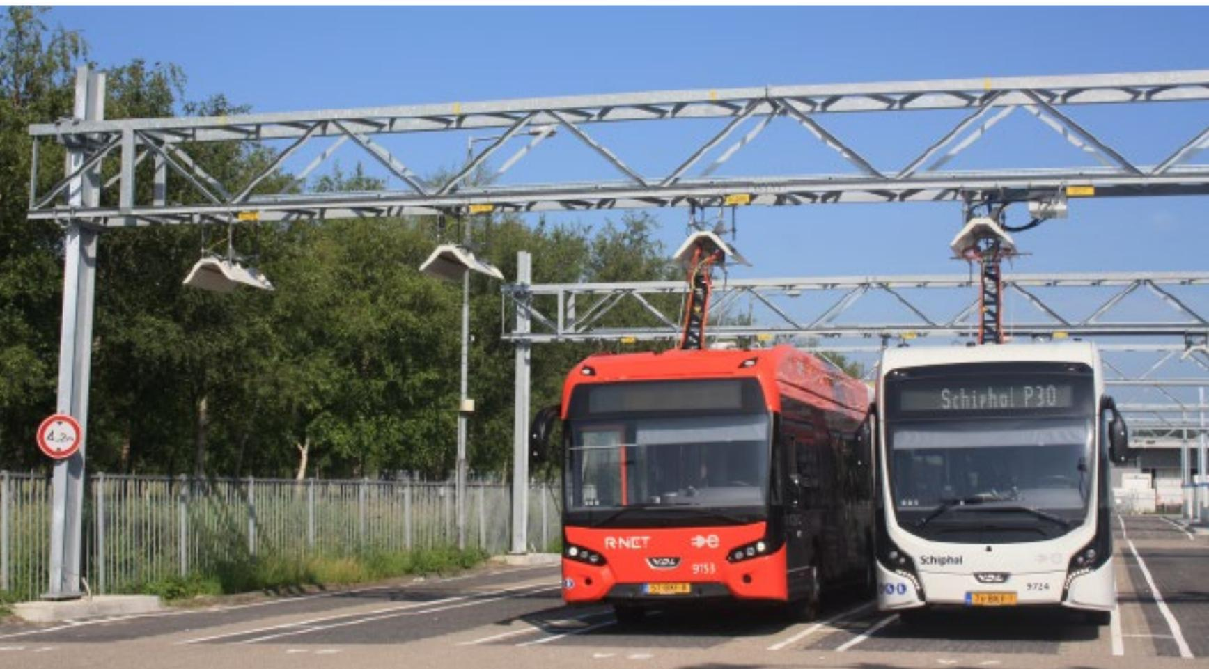
Deux autobus VDL, l'un pour le réseau R-net, l'autre pour celui de Schiphol, sagement alignés côte à côte. Observez le pantographe pour la recharge.
