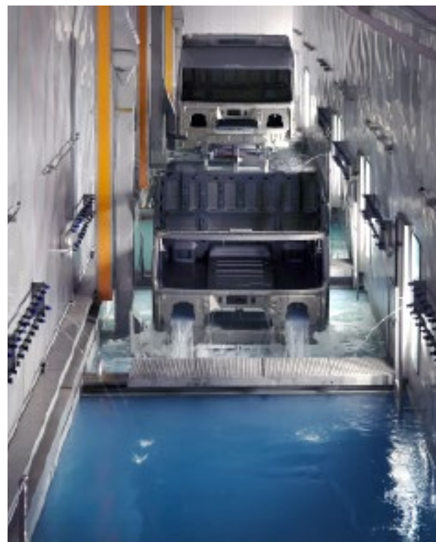
Les cabines peuvent être entièrement immergées et retournées dans ce bain de peinture, qui adhère jusque dans les moindres recoins.
