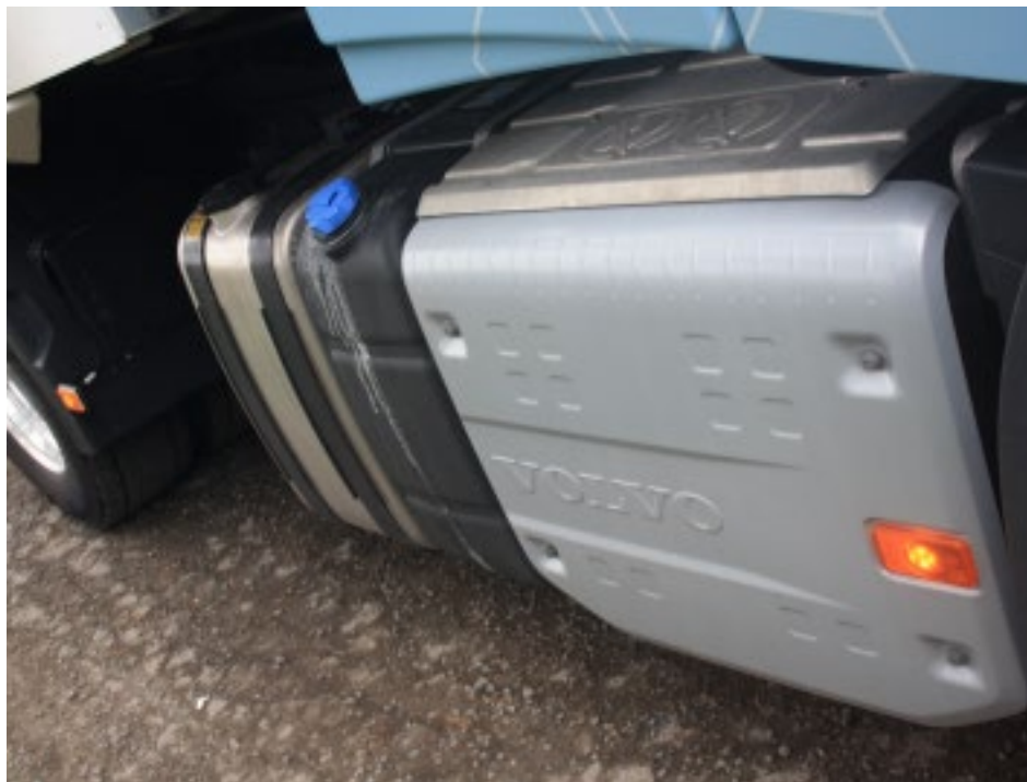
Les réservoirs de Diesel et d'AdBlue sont positionnés sur la droite du châssis.
