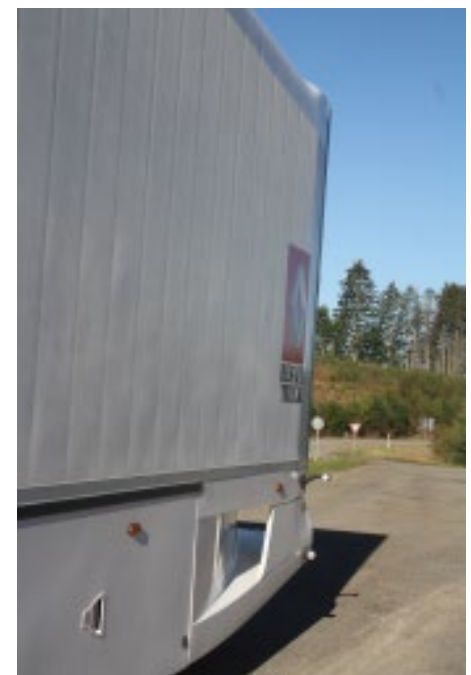
Un équipement sur la remorque carénée : cette ouverture évite la formation de tourbillons d'air à l'arrière de la remorque.
