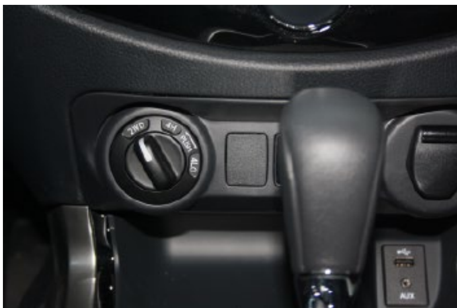
En basculant vers la traction 4 roues motrices, on dispose d'une liaison fixe entre l'essieu avant et l'essieu arrière.
