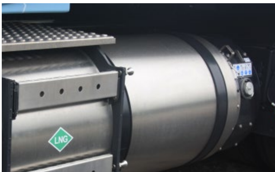
Le réservoir LNG, qui renferme du gaz naturel liquide à température très basse, est situé sur la droite.
