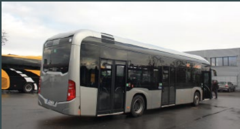
L'eCitaro en 3 portes. Tous les organes électriques sont disposés sur le toit.
