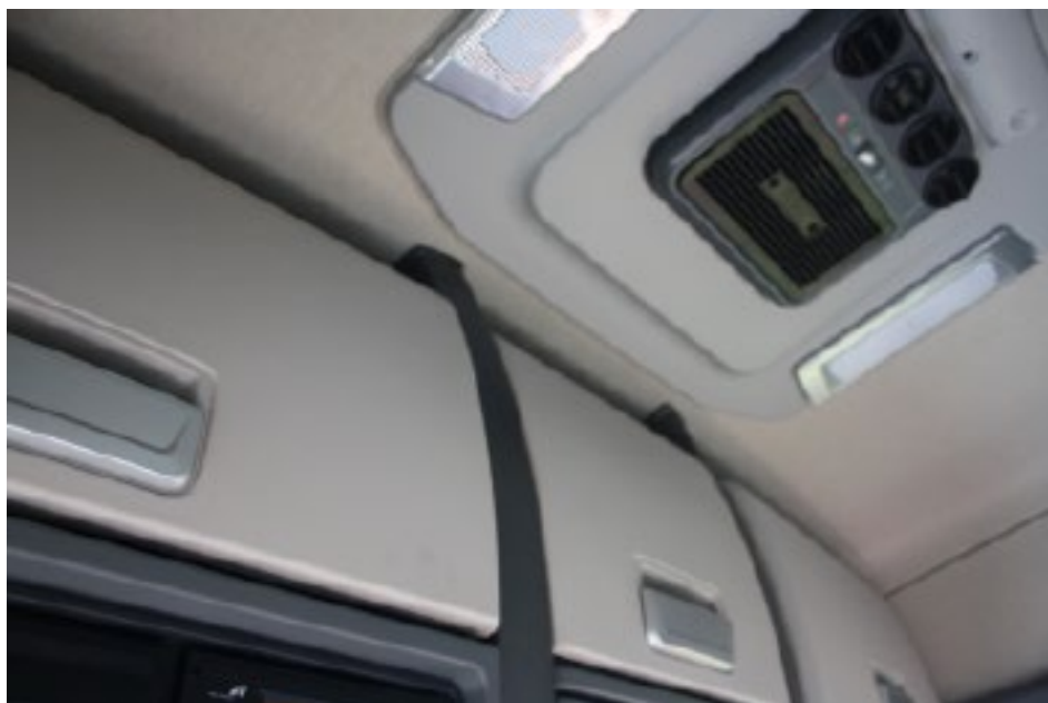
La climatisation d'air et les coffrets au-dessus du pare-brise.
