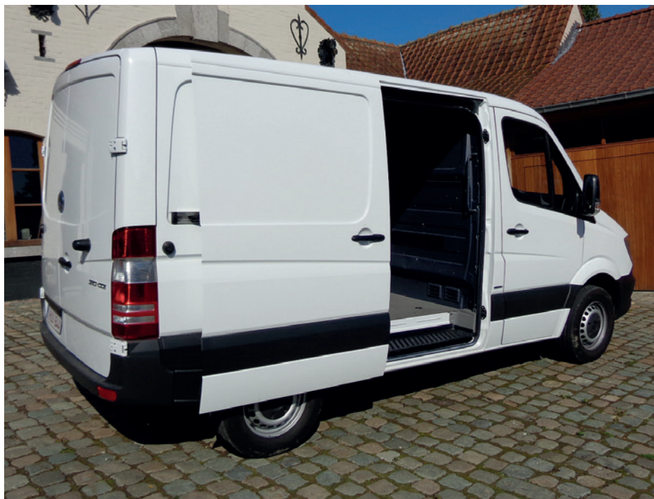
La porte latérale présente une ouverture suffisante de 1050 mm.
