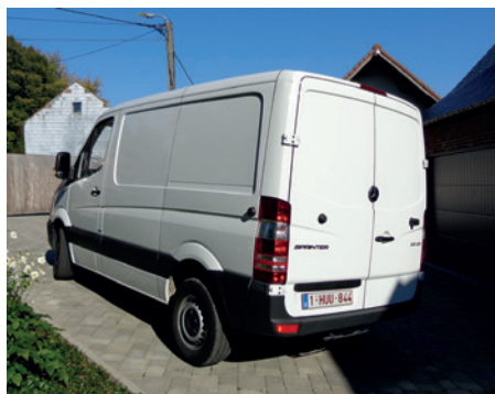
Une languette de protection en plastique protège tout le flanc du véhicule.
