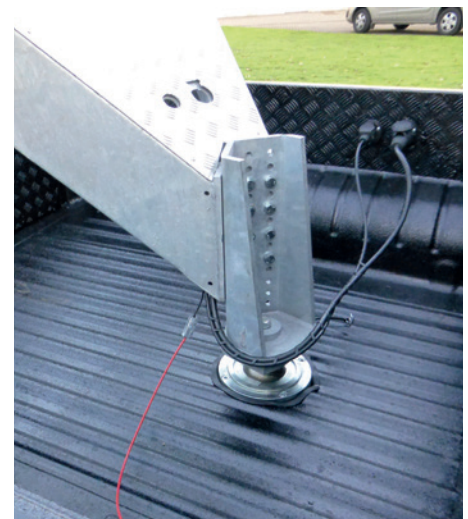
Voici une vue du caisson de chargement, remorque accouplée. Observez l'absence de conduites d'air comprimé, puisque le système de freinage est électrique.
