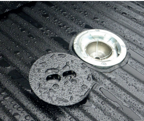
Le point d'accouplement de la remorque est situé au-dessus de l'essieu arrière, dans le bac du pick-up. Les adaptations nécessaires au véhicule sont limitées, de sorte qu'il puisse encore servir à d'autres tâches.
