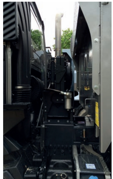
Le refroidisseur de l'Optitrack est un module très compact embarqué à l'arrière de la cabine.
