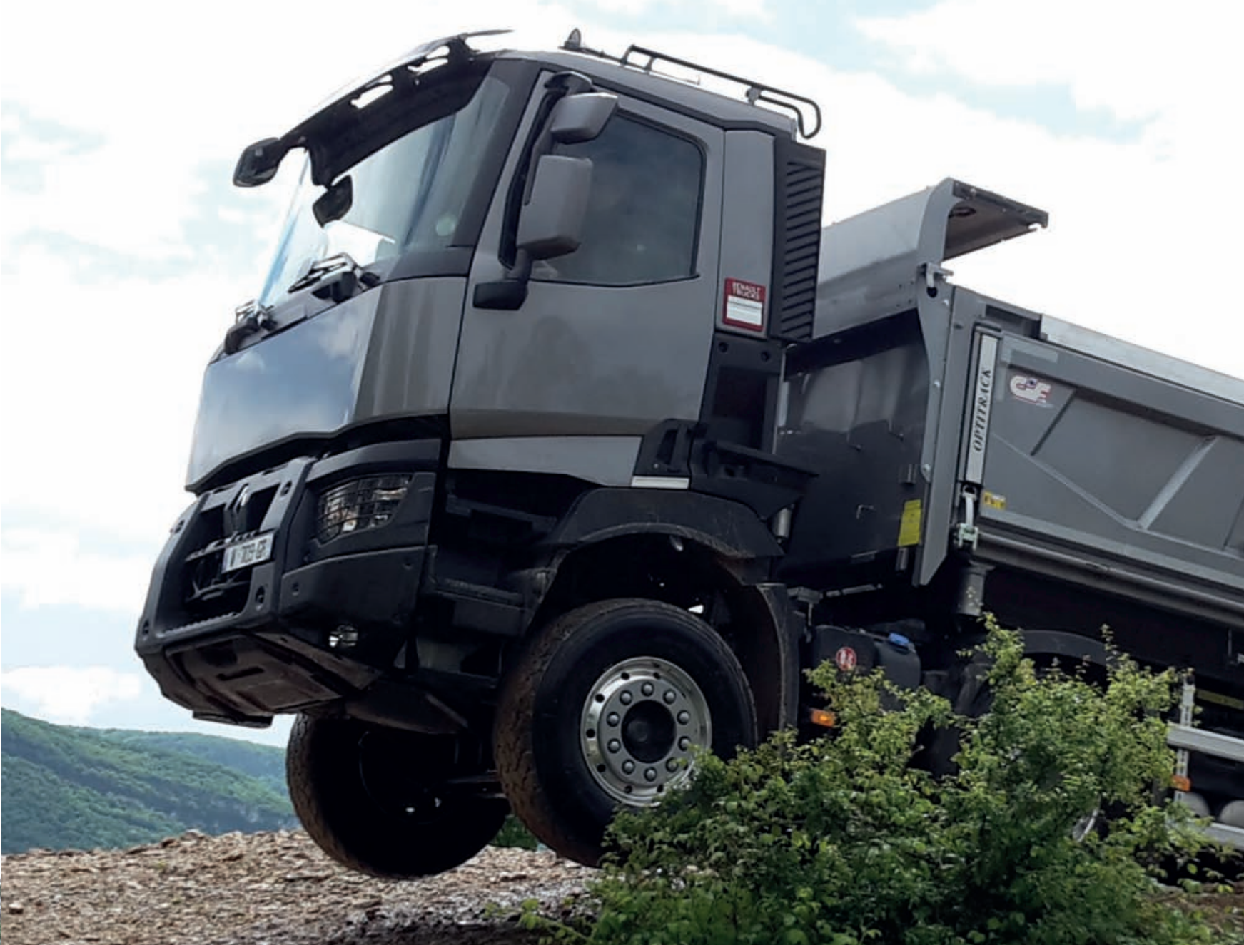
Le deuxième essieu de ce C est équipé de l'Optitrack.
