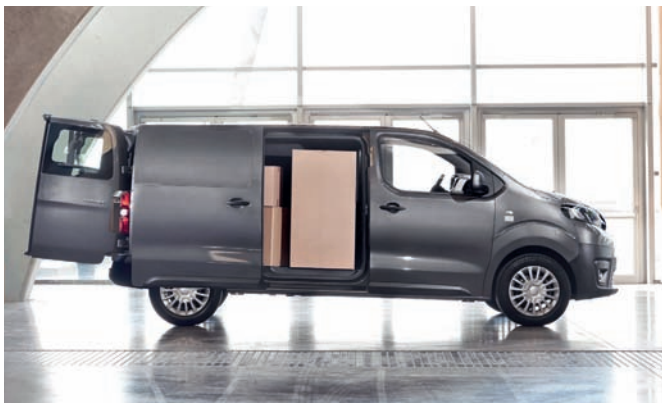
Les portes latérales coulissantes électriques en mains libres sont une innovation inédite dans ce segment. Elles facilitent le déchargement lorsque les bras sont chargés de matériaux, colis ou marchandises.
