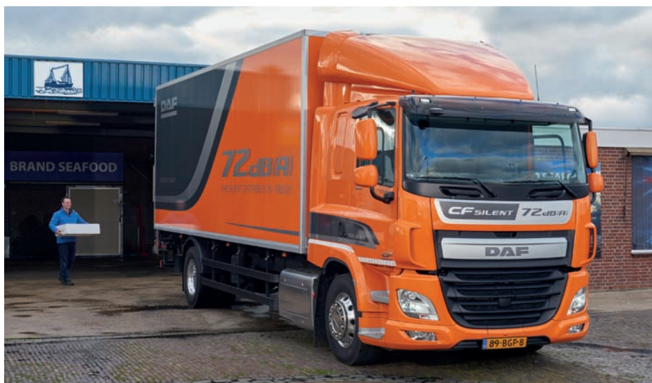
La version Silent du CF dispose notamment d'une isolation sonore de la boîte de vitesses.
