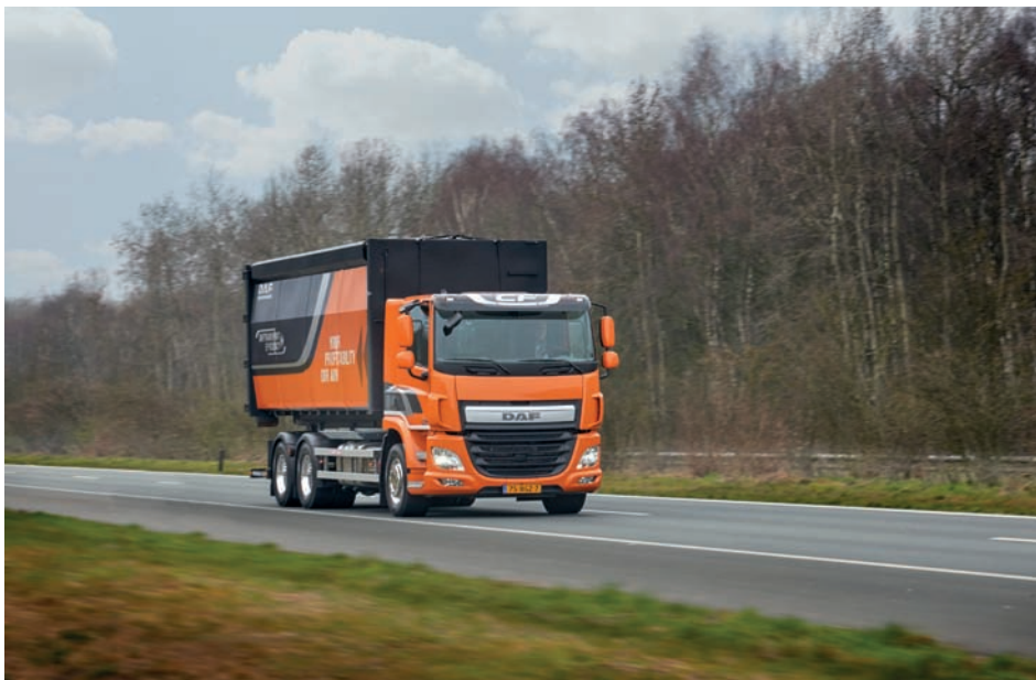
Ce CF 6x2 avec un moteur 7 litres a un essieu suiveur à monte double.
