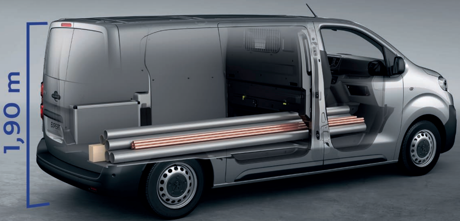
La plate-forme modulaire permet une capacité de chargement utile de 1,4 t, 6,6 m 3 et 2,5 t en traction. L'option Moduwork sert à transporter des objets jusque 4 m de long.
