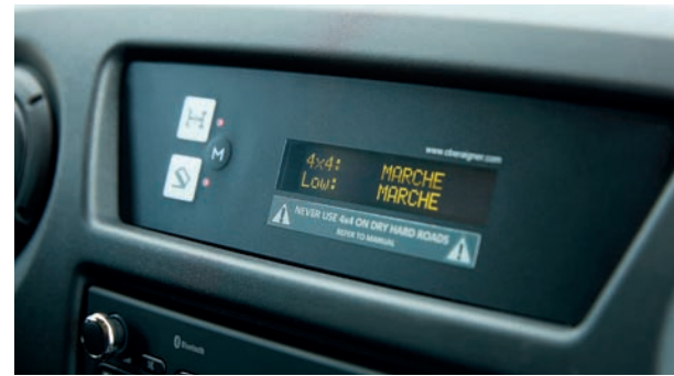
Un écran central sur le tableau de bord du Master 4x4 indique le mode d'entraînement choisi : 4x2 ou 4x4, avec transmission longue ou courte.
